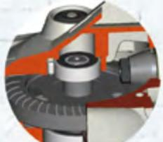
Механически обработанные конические шестерни редуктора для большей надежности.
