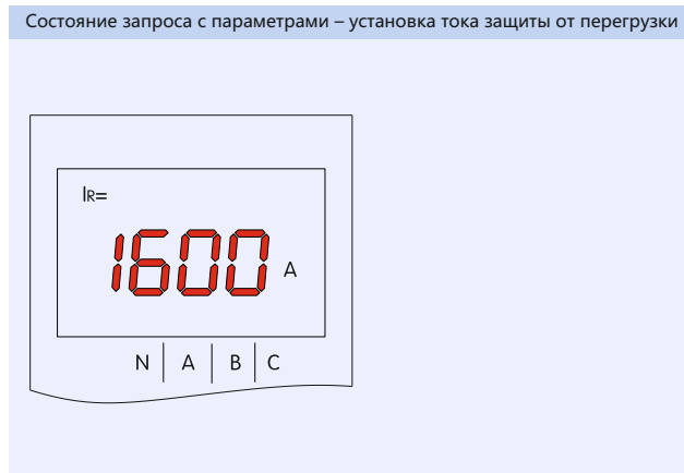
Состояние запроса с параметрами – установка тока защиты от перегрузки
