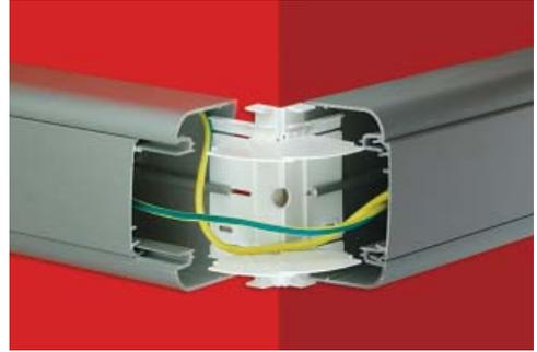
Проводом (код E0001BC) соедините основание одного из коробов с его крышкой. Рекомендуем устанавливать клемму провода (код E0001BC) на расстоянии 16 см от клеммы провода (код E0001B). Вторая клемма провода (код E0001C) защелкивается на направляющую на внутренней стороне крышки. Далее проводом (код E0001C) соедините крышки разных коробов.
