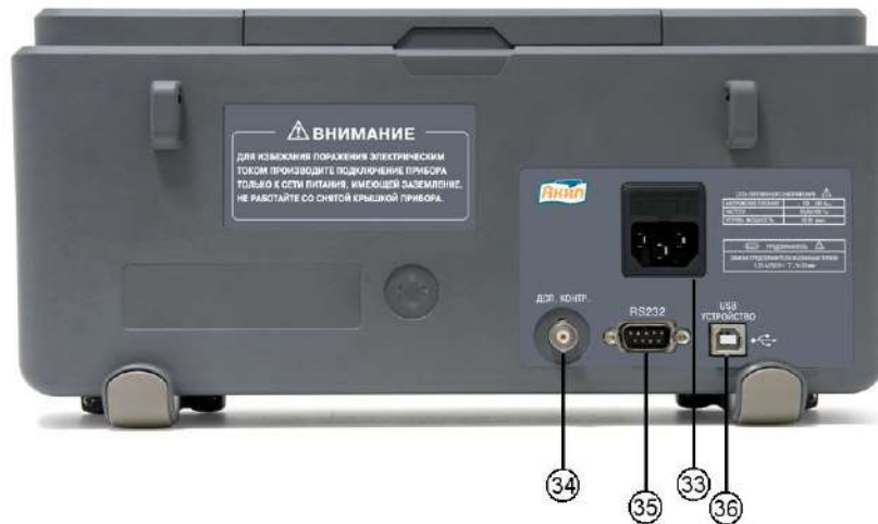
Рис. 6-3 Задняя панель осциллографов АК ИП модели: 4115/1А, 4115/2А, 4115/3А, 4115/4А, 4115/5А, 4115/6А
