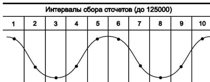
Рис. 8-18 Принцип формирования стандартных выборок
