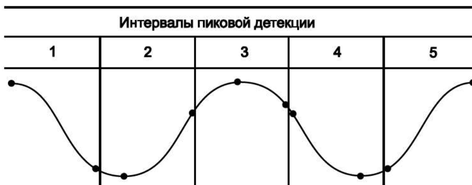
Рис. 8-19. Принцип формирования выборок пикового детектора
