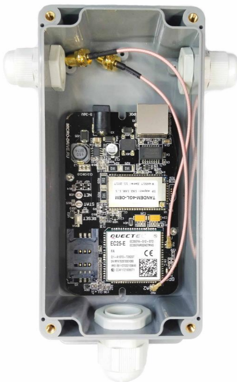
Рис.6.2. Монтаж Tandem-4GL-OEM в гермобоксы «Gainta».
