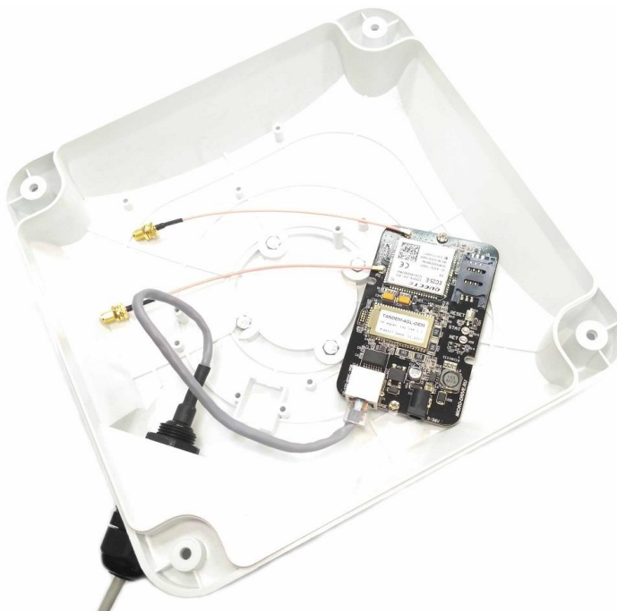
Рис.6.1. Монтаж Tandem-4GL-OEM в герметичную антенну Antex Unibox.
