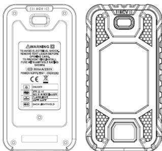
2. Открутите винт и снимите крышку батарейного отсека
