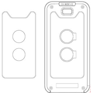
3. Установите батареи в соответствии с полярностью. При успешной установке прозвучит сигнал.
