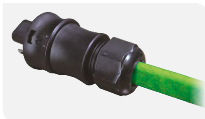
5. Произвести подключение в соответствии с инструкцией по монтажу/ демонтажу разъемов серии RST ® на греющий кабель (стр. 30). Закрутите гайку кабельного ввода. Рекомендуемый момент затяжки 4,0^{+1,0} Нм.
