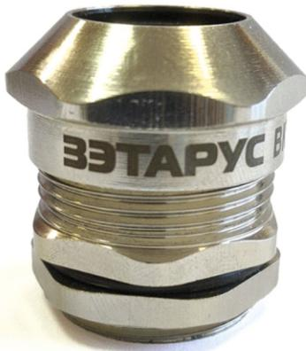
Кабельный ввод с силиконовым уплотнителем ВК1-ЛС-М предназначен для обеспечения безопасного ввода и фиксации небронированного кабеля в корпус электротехнического устройства. С широким температурным диапазоном эксплуатации от -60 до +150 °С
