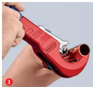
3 Начинаяте рез, постепенно регулируя положение режущего диска специальным синим вентиляем на конце рукоятки
