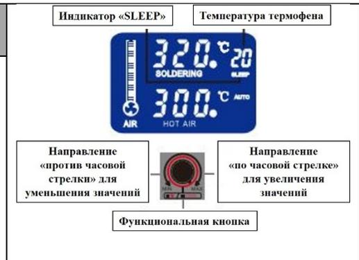
из режима установки параметров функций. Если Вам необходимо произвести установку автоматического / ручного режима работы термофена, нажмите функциональную кнопку еще раз до того, как индикатор «SLEEP» перестанет мигать.
