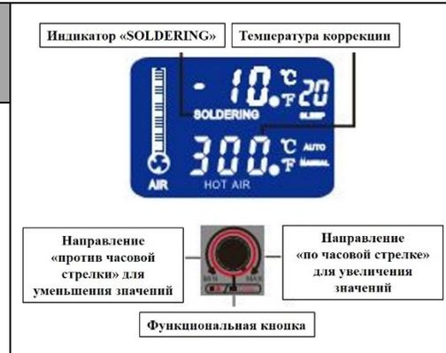
На дисплее отображено значение температуры паяльника «00». С помощью поворотного переключателя установите значение -10. Подождите несколько секунд. Индикатор «SOLDERING» перестанет мигать, установленное значение сохранится в памяти прибора и прибор выйдет из режима установки параметров функций. Если Вам необходимо произвести установку режима температурной коррекции термофена, нажмите функциональную кнопку еще раз до того, как индикатор «SOLDERING» перестанет мигать.
