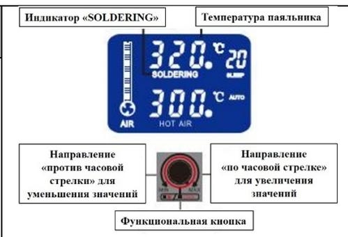
значение 380 с 320. Подождите несколько секунд. Индикатор «SOLDERING» перестанет мигать, установленное значение сохранится в памяти прибора и прибор выйдет из режима установки параметров функций. Если Вам необходимо произвести установку температуры термофена, нажмите функциональную кнопку еще раз до того, как индикатор «SOLDERING» перестанет мигать.
