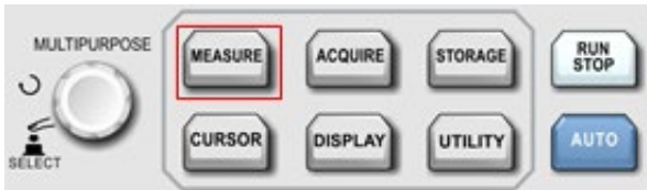
Рисунок 7-1. Функциональная кнопка автоматических измерений
