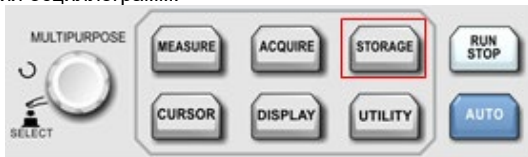
Рисунок 9-1. Функциональная кнопка запоминания STORAGE
