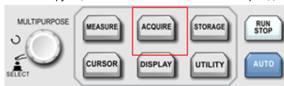
Рисунок 5-1. Функциональная кнопка системы выборки данных.
