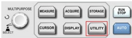
Рисунок 10-1. Функциональная кнопка UTILITY
