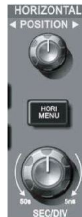
Рисунок 1-7. Зона управления горизонтальной разверткой на панели управления
