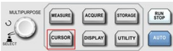
Рисунок 8-1. Функциональная кнопка курсорных измерений
