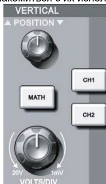
Рисунок 1-6. Зона управления вертикальной шкалой на панели управления
