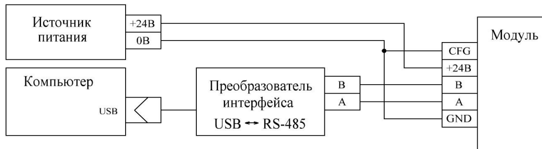
Рисунок 6 – Подключение модуля к компьютеру для конфигурации.
