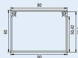
**НАЗНАЧЕНИЕ:** предназначены для прокладки в них скрытым и (или) открытым способами по сгораемым и несгораемым поверхностям как внутри помещений, так и на открытом воздухе электрических, телефонных, компьютерных и телевизионных сетей, работающих при электрическом напряжении постоянного или переменного тока величиной не более 1000 В.
